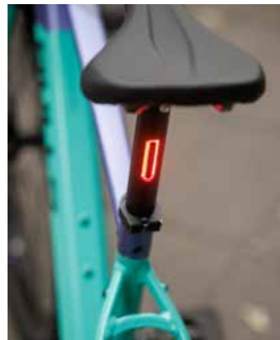
COB-Rücklicht in die Sattelstütze integriert COB rear light integrated into the seat post
