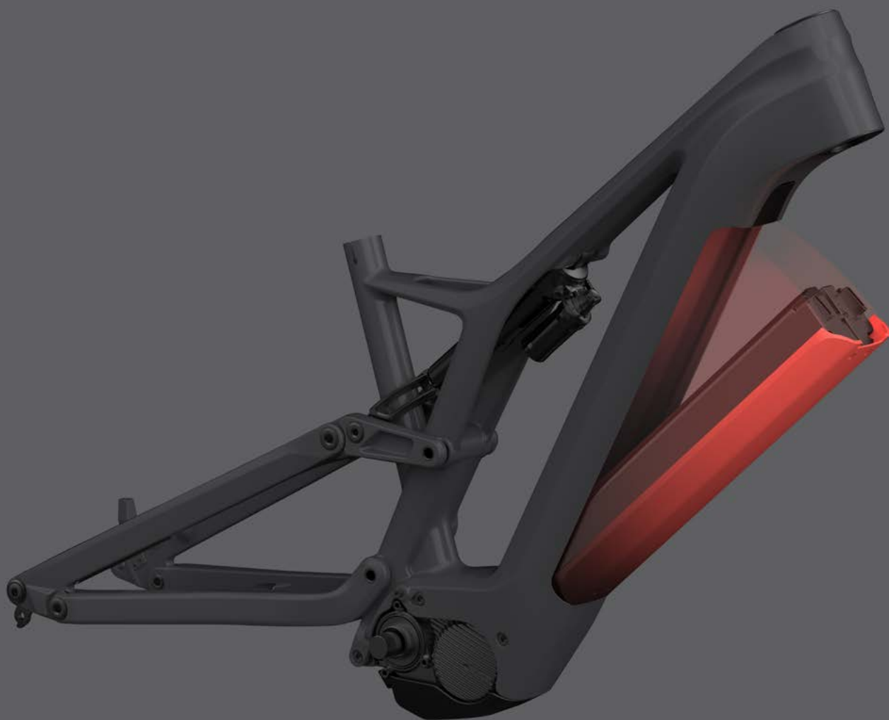
➤ Semi-integrierte Batterie [High Capacity-Modelle]
