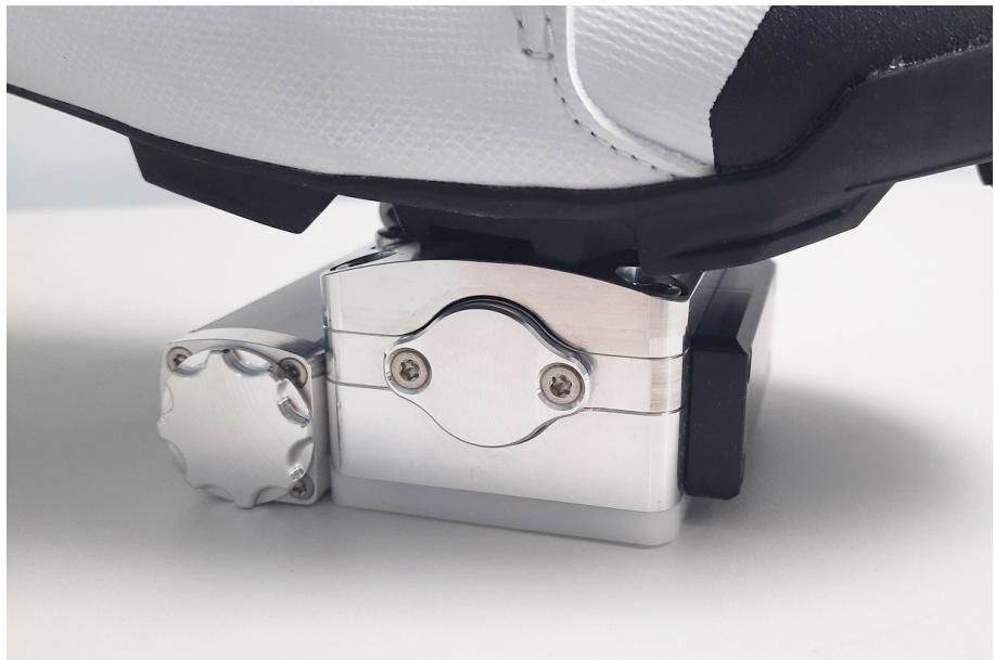
Pedal-Messsystem für Fahrräder&Pedelecs
